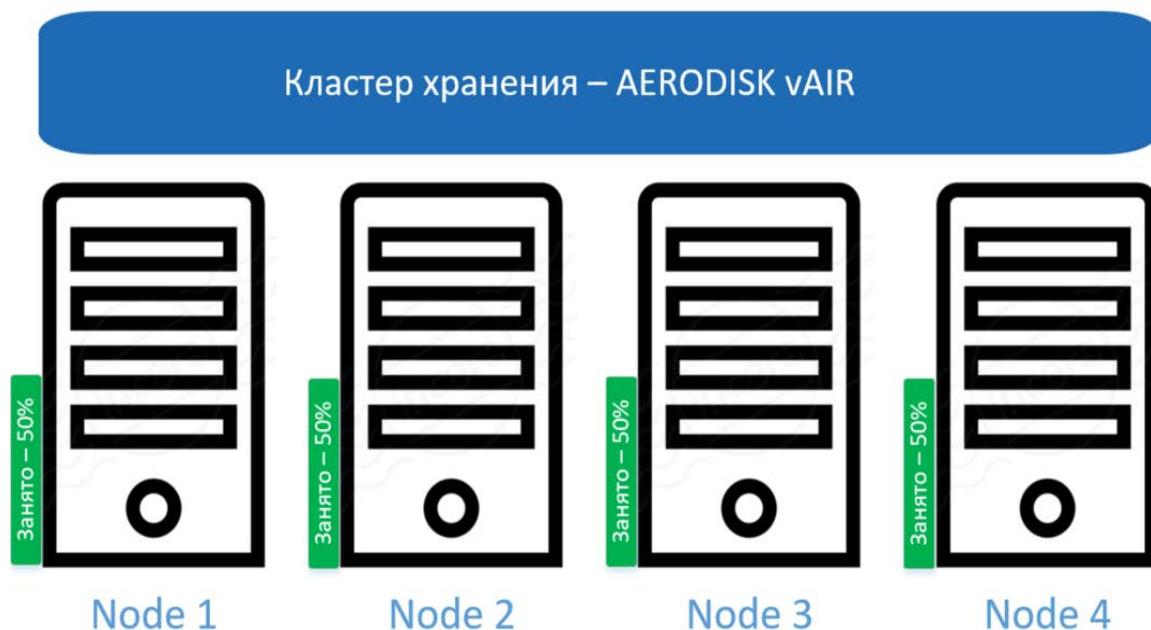
При выходе из строя одного узла данные не перестраиваются, и общий процент использования дисковых ресурсов остается прежним – 50%. Кластер продолжает работать, защита данных отсутствует.
