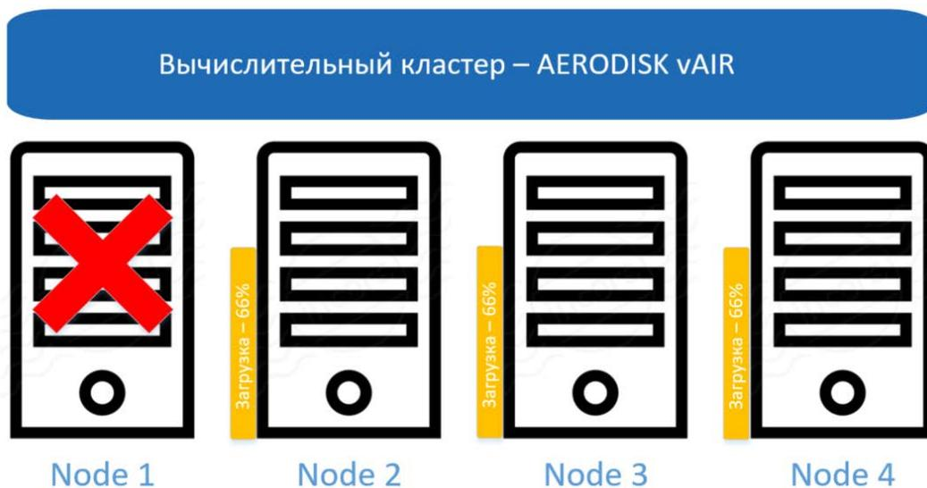
При выходе из строя еще одного узла, VM перезапустятся на соседних узлах, и общая загрузка кластера станет 100%. Кластер продолжает работать, но в нем уже не будет свободных вычислительных ресурсов для перезапуска VM в случае выхода из строя еще одного узла.
