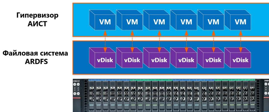
Виртуальные машины, сеть и хранилище работают в рамках одной отказоустойчивой аппаратной платформы. Минимальная конфигурация – 3 узла, максимальная – до 1024 узлов.
