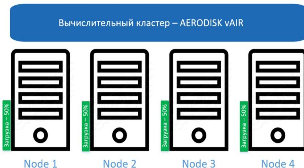
При выходе из строя одного узла, VM перезапустятся на соседних узлах, и общая загрузка кластера станет 66%. Кластер продолжает работать, и в нем еще есть свободные вычислительные ресурсы.
