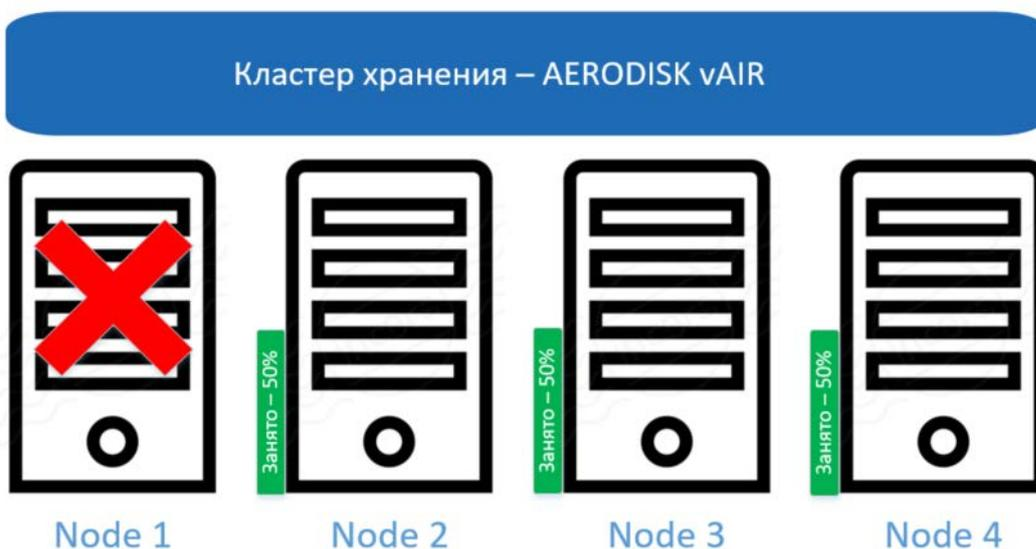
При выходе из строя еще одного узла данные не перестраиваются, и общий процент использования дисковых ресурсов остается прежним – 50%. Физически кластер продолжает работать, но данные потеряны и подлежат восстановлению из резервных копий, так как превышено число узлов, которое кластер может потерять при работе с уровнем защиты EC= 3:1.
